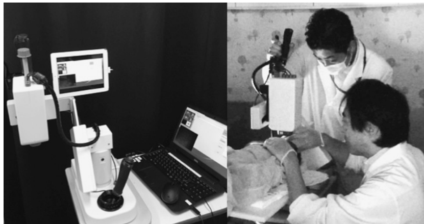
図2 左：新生児用 laser speckle flowgraphy (LSFG)、右：測定風景 睡眠中の新生児の眼瞼を優しく開け測定を行う。検査には3人必要である。
