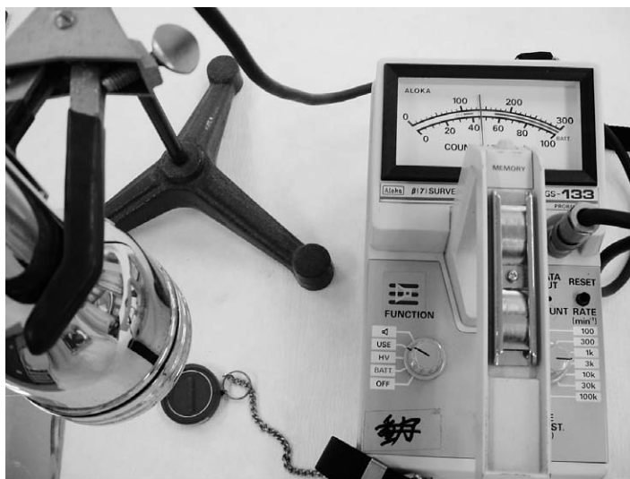
図1 密封線源(校正用 ^{226}\text{Ra} )からの放射線量を測定する様子 写真にある丸いものが校正用線源。金属とアクリルで完全に密閉されていて、通常の扱いでは放射性物質が外部へ漏れることはない。線源の上に遮蔽用の板を1枚ずつ徐々に重ねて置き、その都度サーベイメーターの指示値を読む。実験の操作は極めて単純である。
